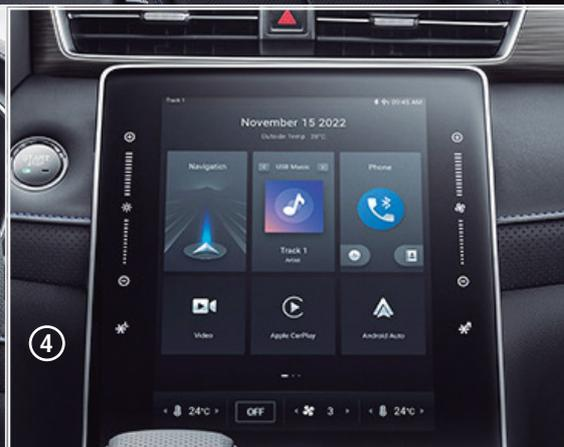
1) Techo panorámico 50/50 2) Panel central con Smart Shift, Freno de estacionamiento electrónico EPB, Autohold y control de descenso 3) Clúster digital 12.3" TFT 4) Pantalla vertical de 14.1" con Android Auto® y Apple CarPlay®
